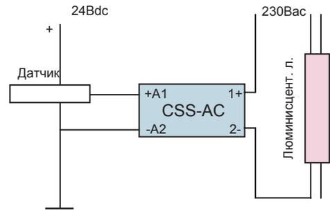
Световой контроль с люминесцентными лампами, посредством датчика
