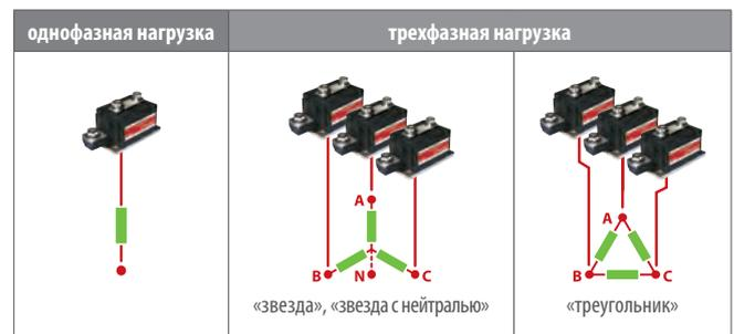
Применение отдельного ТТР для каждой из 3-х фаз повышает надежность коммутации, а следовательно, и всей системы управления в целом.
