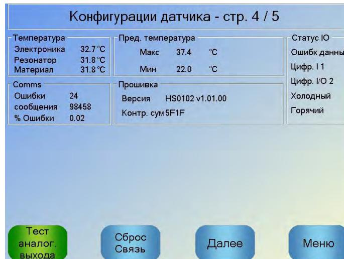
**Рис. 31: Экран конфигурации датчика – Страница 4**
