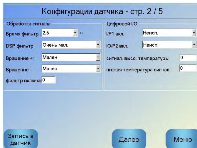
**Рис. 29: Экран конфигурации датчика – Страница 2**
