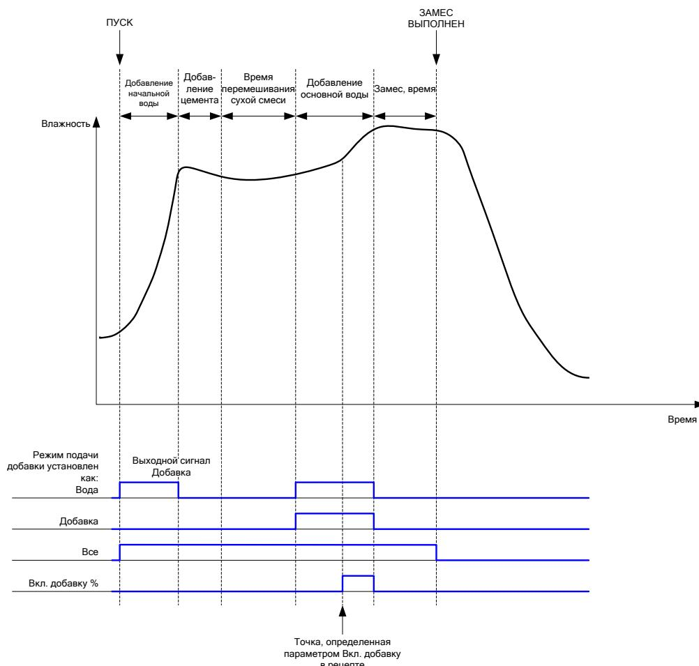
Рис. 44: Выходной сигнал Добавка в нормальном цикле замеса
