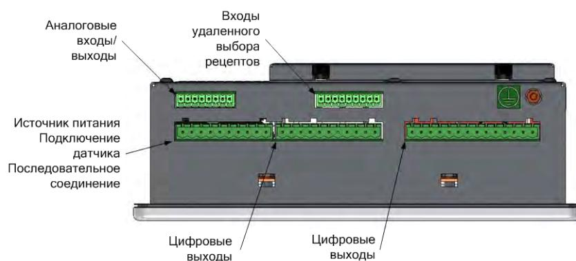
**Рис. 9: Нижняя сторона блока управления с указанием разъемов**
