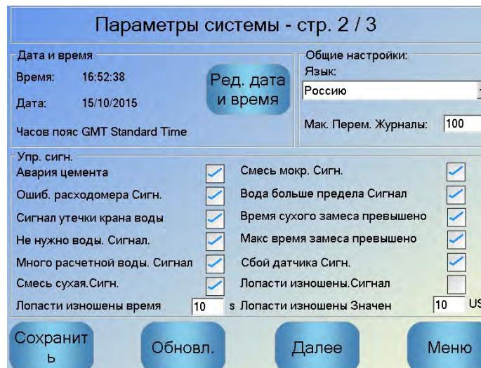
Рис. 24: Второй экран параметров системы
