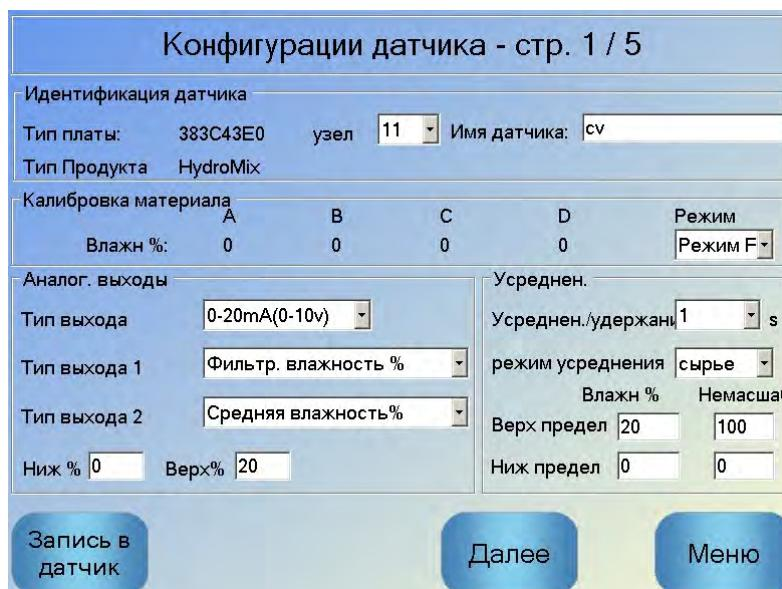
Рис. 28: Экран конфигурации датчика – Страница 1
