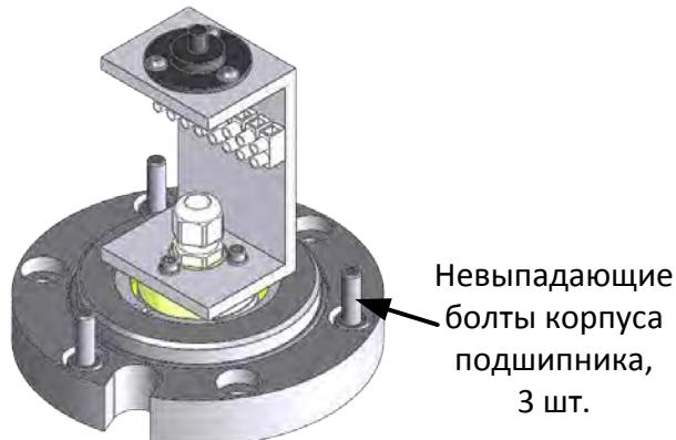
Рисунок 36: Корпус подшипника с установленными невыпадающими болтами
