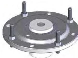
Рисунок 24: Установка крепежных штифтов
