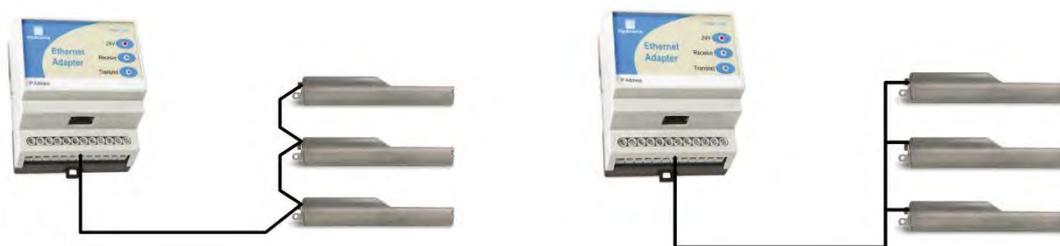
**Рис. 22: Правильно выполненные кабельные соединения сети RS485**
