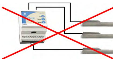
**Рис. 23: Неправильно выполненные кабельные соединения сети RS485**
