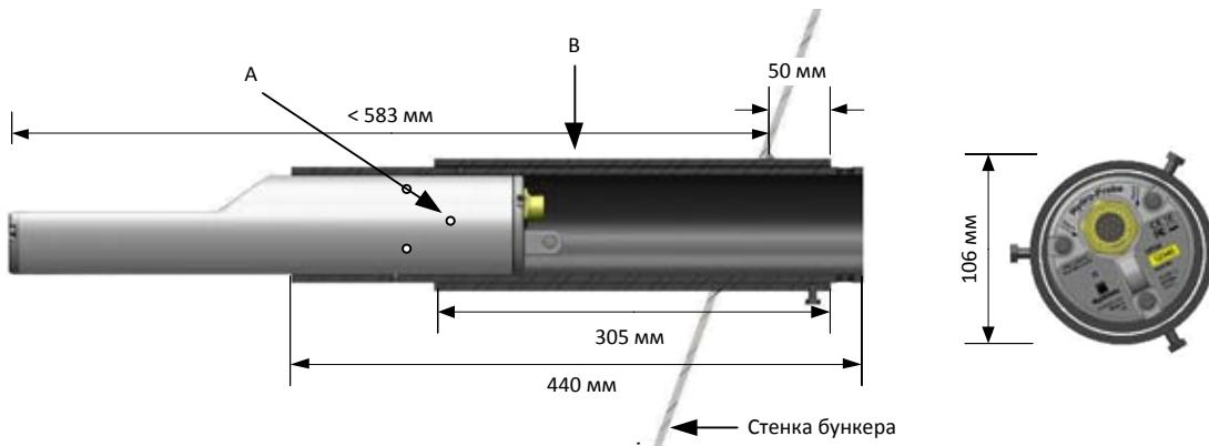
А – Датчик крепится к внутренней втулке с помощью 6 винтов с шестигранной головкой (например, Locktite) на резьбе
