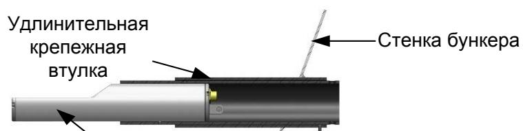
Рисунок 18: Датчик Hydro-Probe, установленный в удлинительной крепежной втулке
