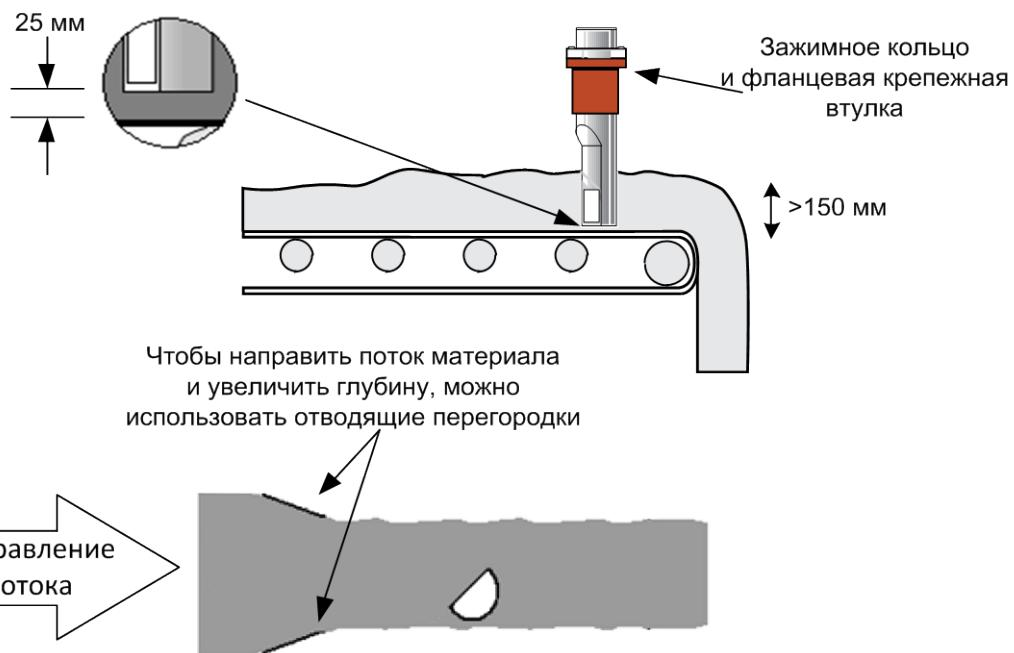
**Рисунок 9: Монтаж датчика Hydro-Probe на ленте конвейера**
