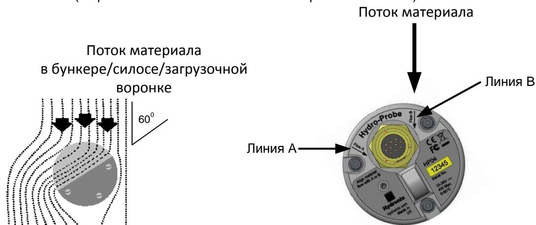
Рисунок 2: Угол установки Hydro-Probe и поток материала
