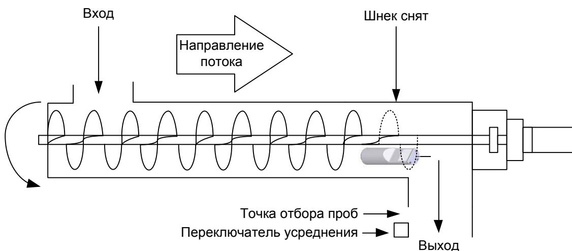
Рисунок 12: Монтаж датчика Hydro-Probe на шнековом конвейере
