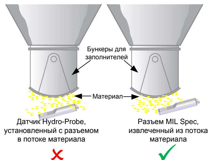
Рисунок 17: Датчик Hydro-Probe, установленный под бункером для заполнителей
