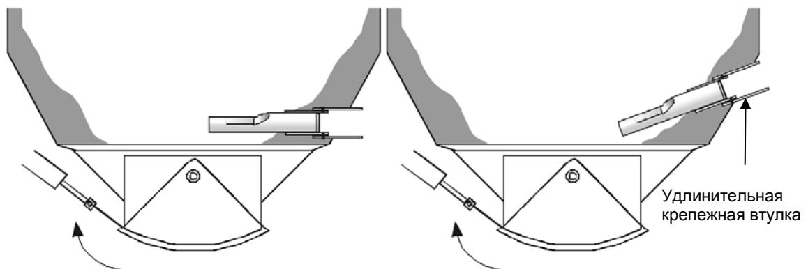
Рисунок 7: Монтаж датчика Hydro-Probe в больших бункерах
