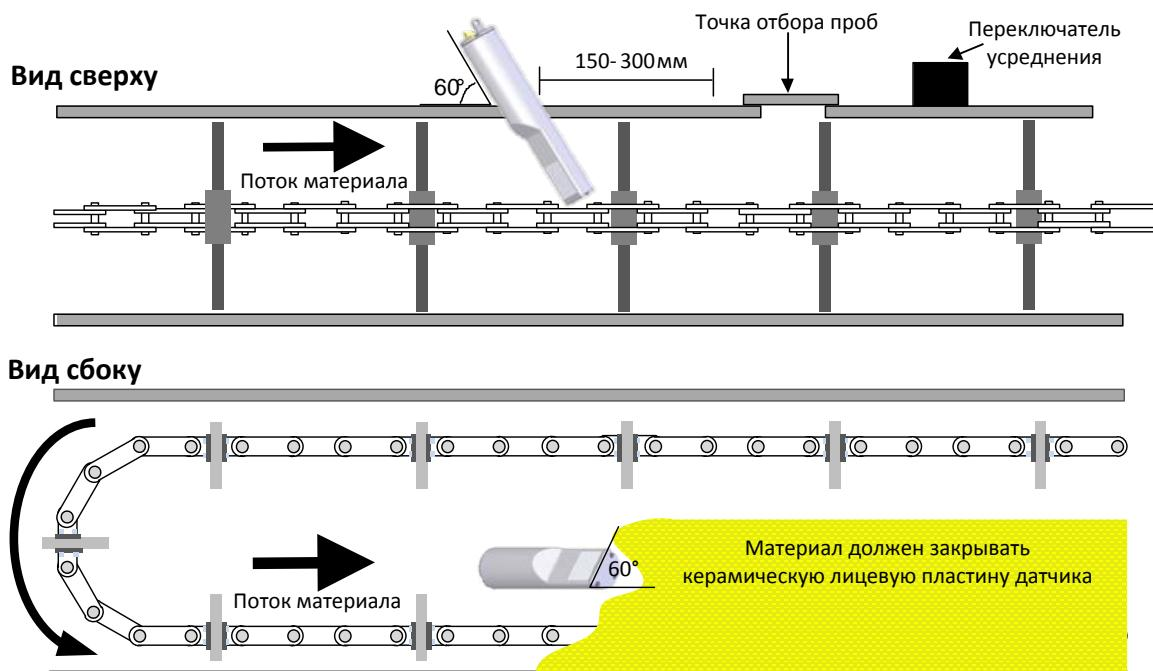
**Рисунок 11: Монтаж датчика Hydro-Probe на конвейере для сыпучих материалов**
