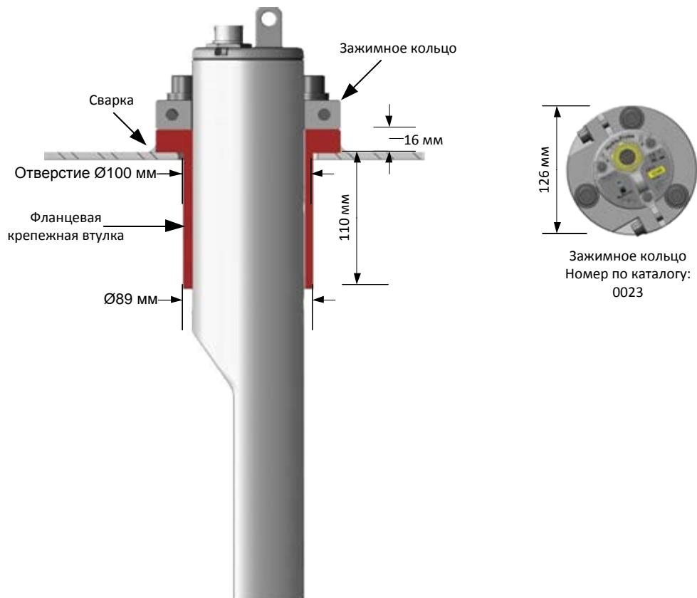
Рисунок 16: Фланцевая крепежная втулка (№ по каталогу 0024A)
