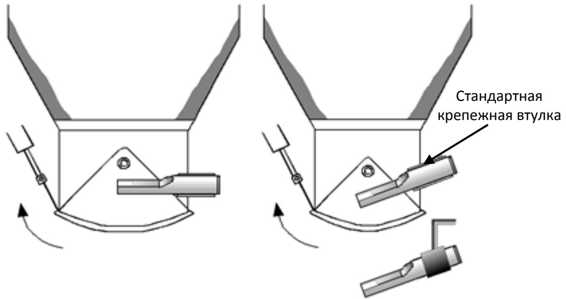
Рисунок 5: Монтаж датчика Hydro-Probe в горловине бункера
