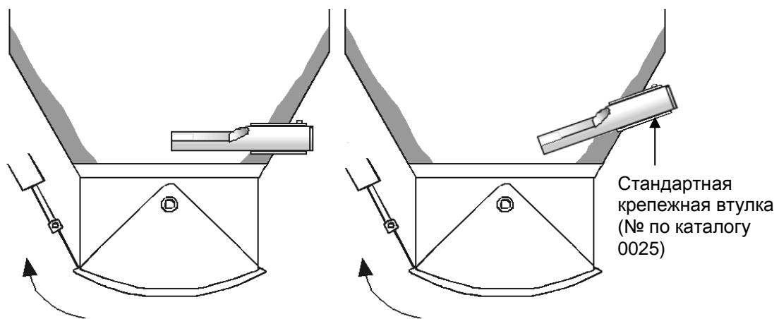
Рисунок 6: Монтаж датчика Hydro-Probe на стенке бункера
