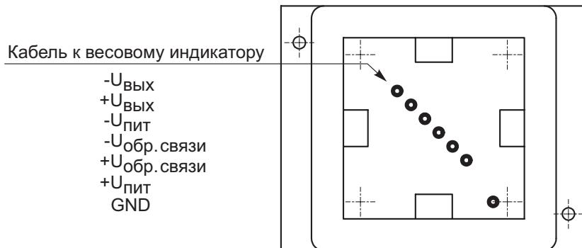
**Примечание:** цвета жил указаны согласно маркировке Flintec. При подключении датчиков других производителей цвета могут отличаться.
