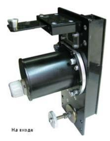
Микроволновой поточный влагомер Микрорадар 125 единственный из существующих влагомеров, предназначенный для измерения влажности свежеувлажненного, мокрого зерна. Используются при регулировании доувлажнения зерна при его подготовке к помолу. В составе прибора имеется два блока сенсора, один из которых монтируется входе на
