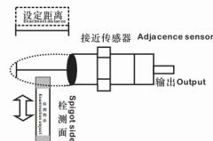
包括温度、电压影响在内，没有误动作从能实用的检测面到检测面到检测物体通过位置的距离。
