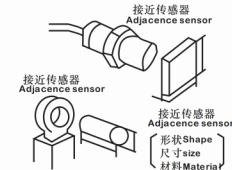
为测定基本性能作为标准的检测物体，形状、尺寸、材料已决定的。
