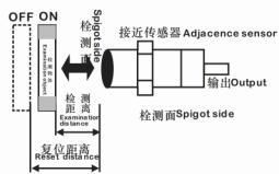
按指定方法移动检测物体，从基准位置（基准面对到测定动作（复位）的距离）
