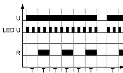
Включение напряжения питания  $U$ , начинает отсчёт установленного времени  $T$ . После отсчёта времени, наступает срабатывание исполнительного реле  $R$  и снова начинается отсчёт времени  $T$ . Циклическая работа реле длится до момента выключения напряжения питания  $U$ .
